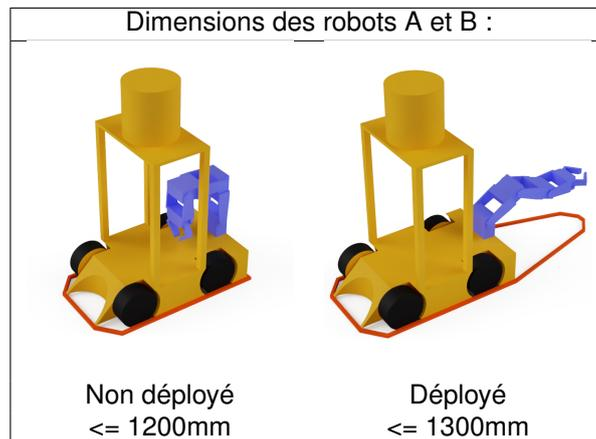
Le périmètre d'un robot ne doit pas excéder 1200 mm au moment du départ. Le périmètre de ce robot totalement déployé ne doit pas excéder 1300 mm au cours du match. Il est accepté que la forme de l'enveloppe convexe du robot projeté au sol change dynamiquement, tant que le périmètre du robot respecte à tout instant les contraintes de périmètre maximal.
