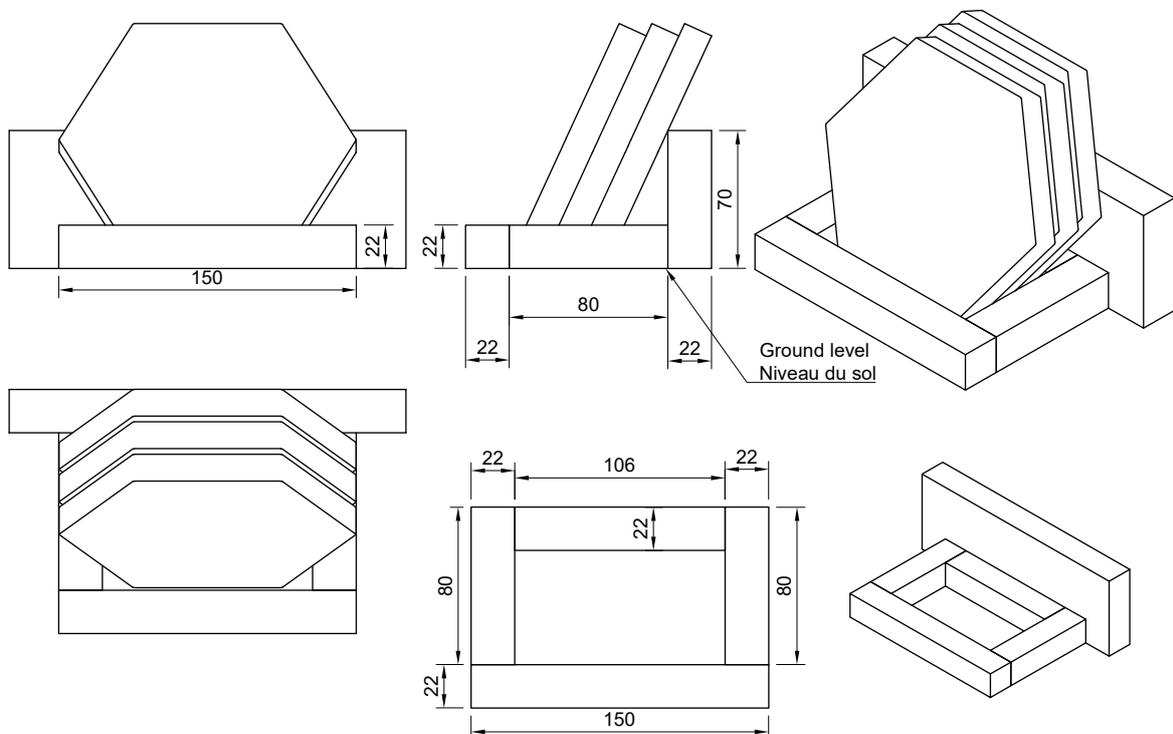
FIGURE 24 – Support échantillon sur table
