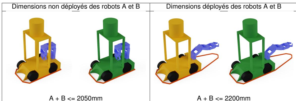
La somme des périmètres des deux robots au départ du match ne doit pas dépasser 2050 mm. La somme des périmètres déployés des deux robots ne doit pas excéder 2200 mm. Attention, la somme des périmètres déployés est égale à la somme du maximum du périmètre de déploiement de chacun des deux robots pendant toute la durée du match. Un robot ne peut donc pas réduire son périmètre durant le match pour permettre à un second robot de se déployer plus.
