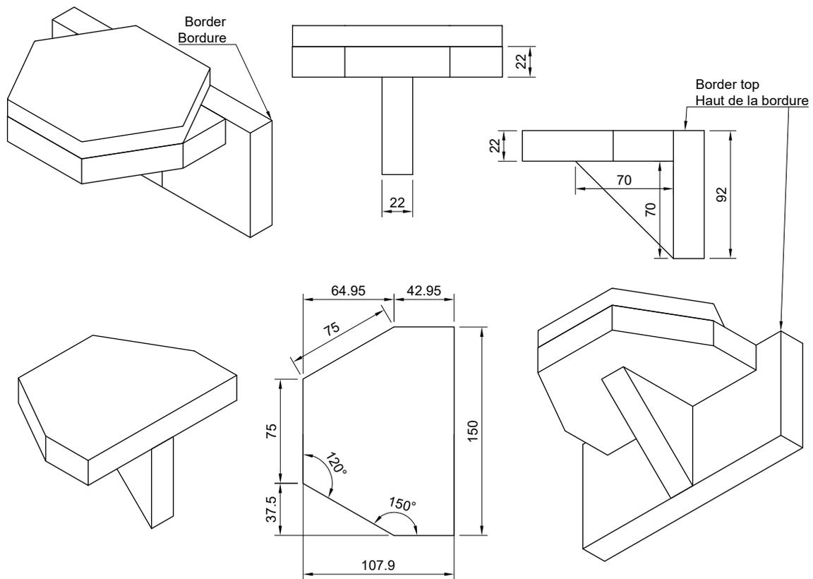
FIGURE 23 – Support échantillon sur le bord de table
