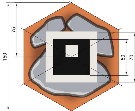
FIGURE 21 – Echantillon et tag ArUco
