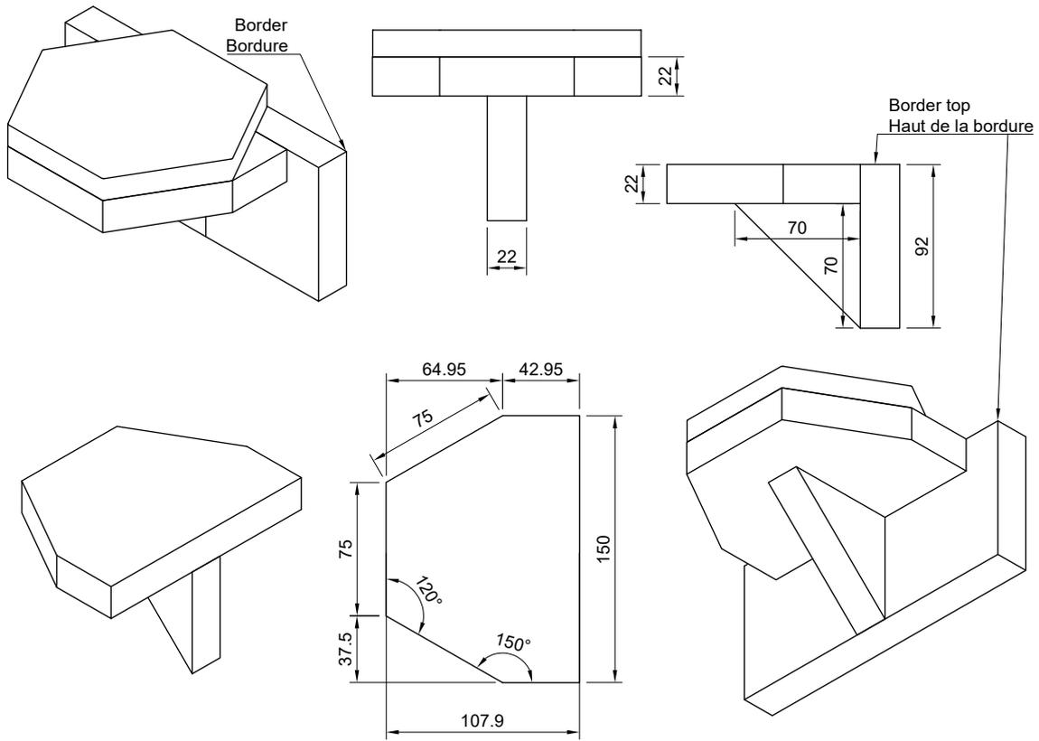
FIGURE 21 – Support échantillon sur le bord de table
