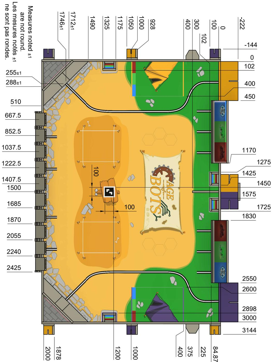
FIGURE 17 – Vue du dessus de la table de jeu sans les échantillons
