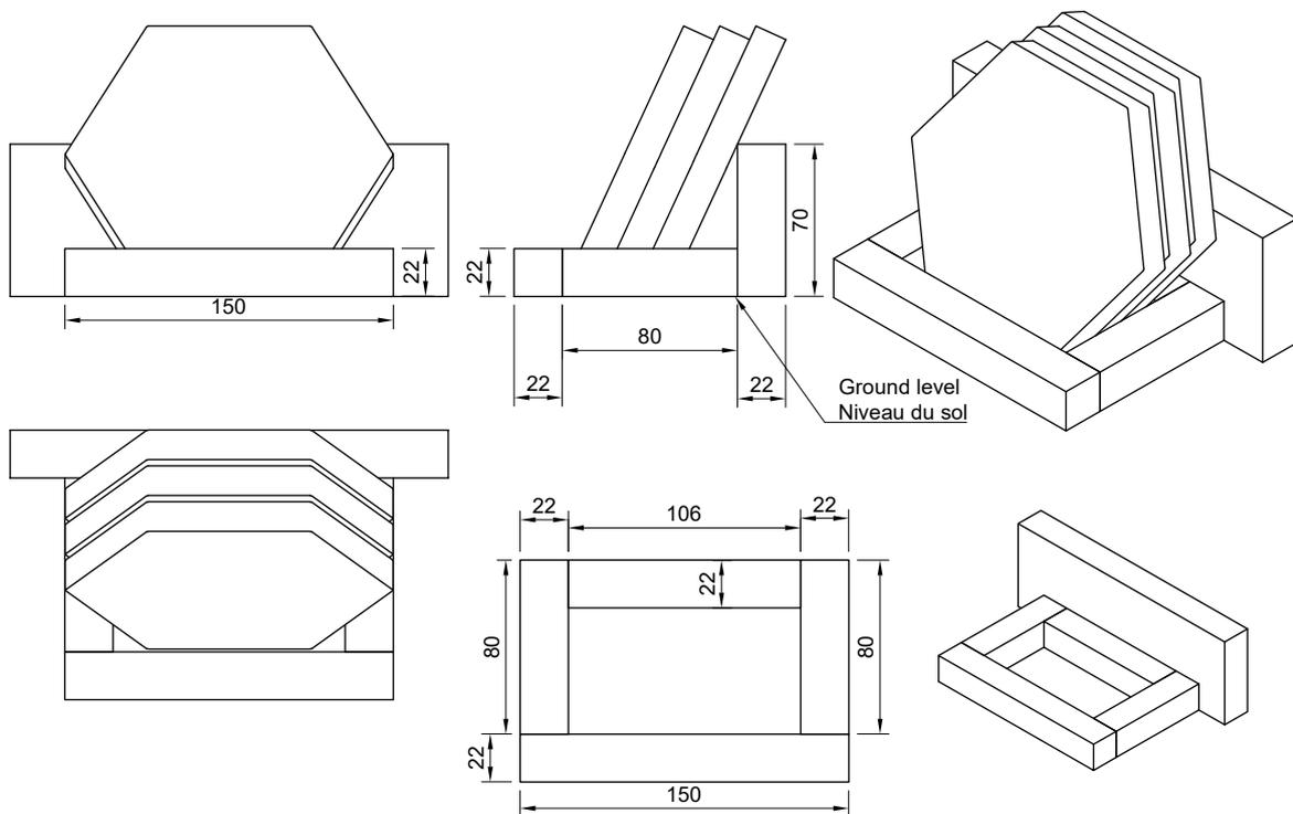
FIGURE 22 – Support échantillon sur table
